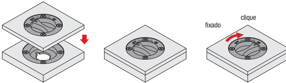
Certificar-se de que o manípulo esteja na posição „OFF“. Insira a trava rotativa de fixação modelo on/off na placa de fixação e gire o manípulo para a posição „ON“. Ao atingir o ponto de aperto, o dispositivo emite um clique audível.
