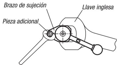
Si monta una pieza adicional sobre el brazo de sujeción, asegure el brazo de sujeción con una llave inglesa para que no absorba ninguna fuerza de torsión.
