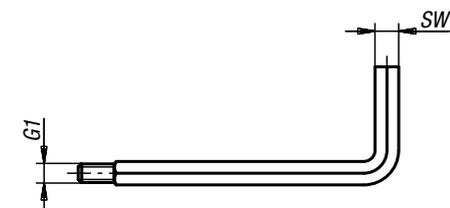
Cet outil est une clé hexagonal avec un embout fileté. Visser la clé dans le taraudage G1 de la vis cylindrique pour positionner ou desserrer le tampon tangent
