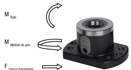
\* Hasta una fuerza transversal de 1.500 N queda garantizado el funcionamiento correcto de los módulos de sujeción, especialmente la precisión de repetición. Hasta una fuerza transversal crítica de 14.000 N se garantiza la seguridad personal y frente a los fallos de los módulos de sujeción.
