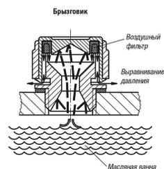
При работающей в масляной ванне трансмиссии возникает опасность выхода вытесняемого масла через вентиляционный винт. Чтобы это предотвратить, следует установить направляющий щиток (брызговик). Благодаря этому уменьшенное отверстие доходит только до части распылителя. Он направлен на дно крышки таким образом, чтобы масло отводилось, не мешая вентиляции.
