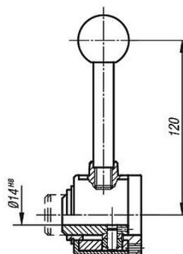
Con eje transversal en la perforación
