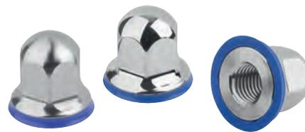
El sistema de atornillado Hygienic DESIGN se ha desarrollado especialmente para usos en ámbitos de procesamiento de alimentos. Se ha hecho gran hincapié en una forma geométrica optimizada para la limpieza y una rugosidad superficial de  $Ra \leq 0,8 \mu m$ . La aplicación rápida y sencilla del producto gracias a su junta tórica ya premontada completan el conjunto.
