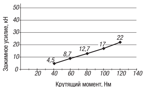
Зажимное усилие 3-осевого зажима
