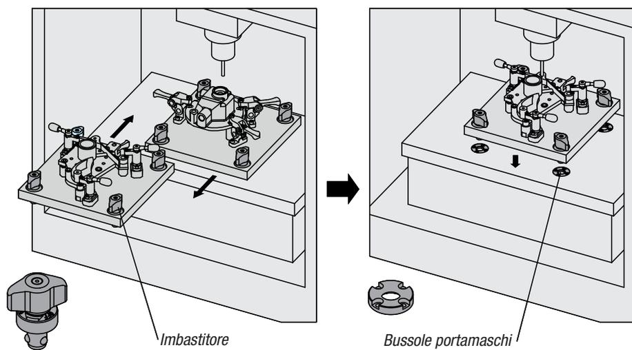
Cambio del dispositivo di saldatura
