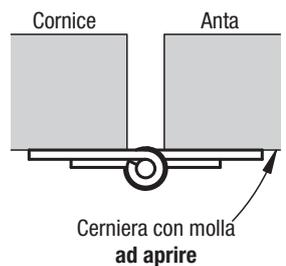
La freccia indica la rotazione dell'anta sotto l'effetto della molla.
