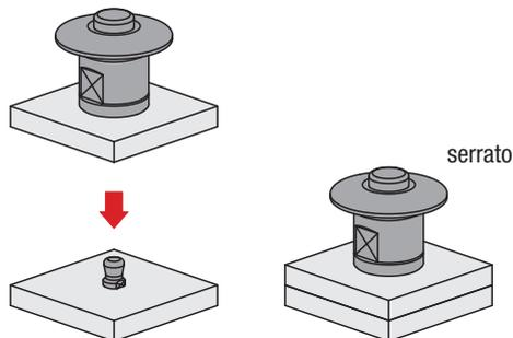
Inserire la chiusura a pressione sul bullone di fissaggio senza premere il pulsante, in tal modo la chiusura viene bloccata.
