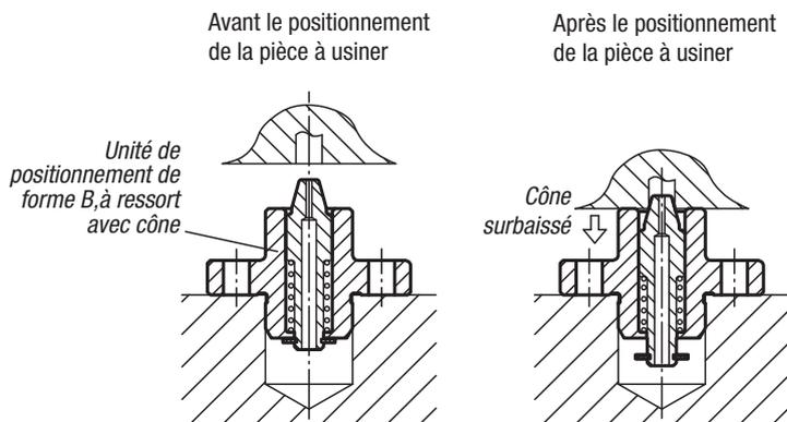
Lors de la mise en place de la pièce sur l'unité de positionnement, le cône est déplacé vers le bas.
