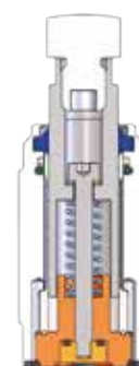
Включение усилием пружины
