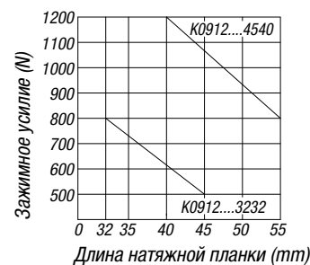
Длина натяжной планки C относительно зажимного усилия
