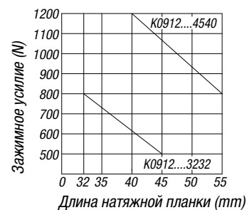
Длина натяжной планки C относительно зажимного усилия
