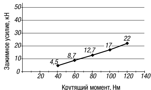
Зажимное усилие 3-осевого зажима
