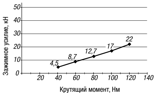
Зажимное усилие 3-осевого зажима
