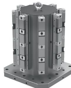
Конструкционная система зажима установлена на сменную паллету.
