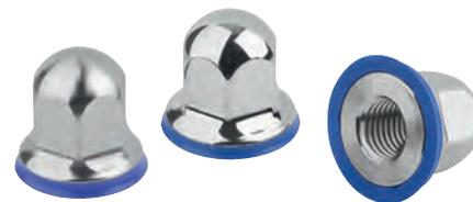
Le système de vis Hygienic DESIGN a été développé spécialement pour une utilisation dans les zones de transformation des aliments. Une attention particulière a été accordée à la géométrie optimisée pour le nettoyage et à la rugosité de surface de  $Ra \leq 0,8 \mu m$ . L'utilisation simple et rapide des produits grâce -à une bague d'étanchéité prémontée vient compléter l'ensemble.
