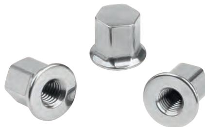
Seule l'association avec la rondelle d'étanchéité Hygienic USIT® permet de garantir une étanchéité sans zone de rétention. Les écrous borgnes polis présentent une rugosité de surface  $Ra < 0,8 \mu m$ . En outre, les jonctions internes sont conçues avec un rayon minimal de 3 mm, ce qui empêche l'adhérence de particules de saleté et garantit un nettoyage facile.
