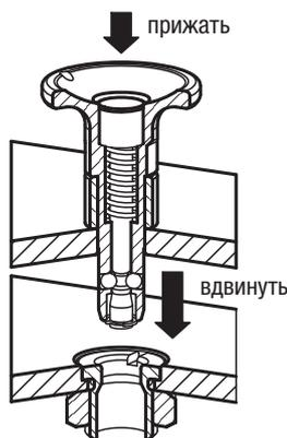
Нажатием кнопки вдвиньте стопорные шариковые пальцы в установочную втулку.
