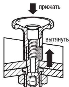
Для извлечения: нажатием кнопки вытяните стопорный шариковый палец из установочной втулки.
