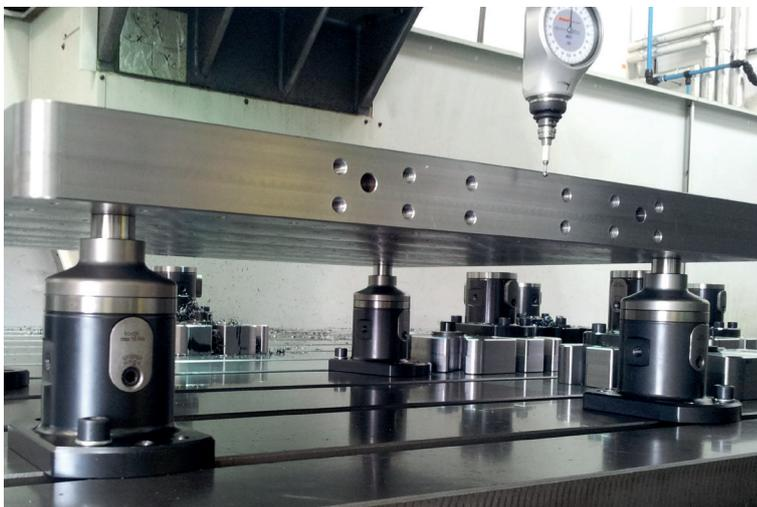
4 modules de base doubles placés sur une table à trous. Usinage optimal sur 5 faces.
