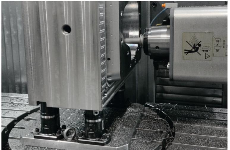
2 modules de base avec tenons de centrage adaptés directement sur un système de bridage à point zéro.
