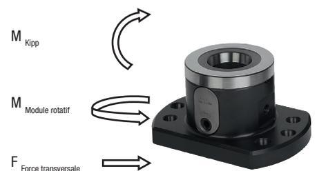
\* Jusqu'à une force transversale de 1.500 N, le fonctionnement correct des modules de bridage, notamment en ce qui concerne la répétabilité, est garanti. Jusqu'à une force transversale critique de 14.000 N, la sécurité en cas de défaillance et la sécurité des personnes sont garanties pour les modules de bridage.
