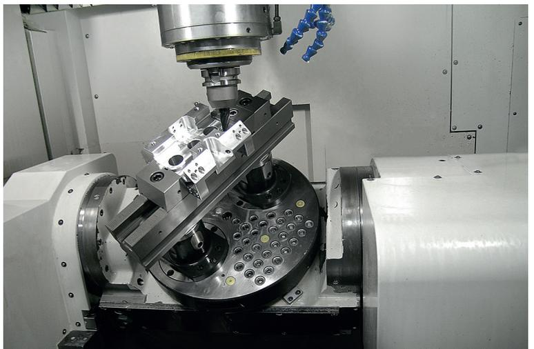
Procédé de chargement d'une pièce à usiner longue et lourde, installée sur 3 modules de base. Les tenons de serrage ont été directement montés sur la pièce. Le positionnement de la pièce s'effectue lors du bridage.
