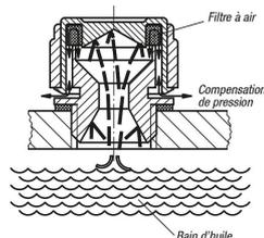
Les transmissions graissées par barbotage dans un bain d'huile présentent un risque certain de fuite d'huile par le bouchon à évent. Pour parer à cette éventualité, nos bouchons à évent sont munis d'une chicane (dispositif anti-projection). Seul un jet d'huile ultra fin peut pénétrer dans l'alésage, dont le diamètre s'amenuise à mesure qu'il progresse vers l'évent. Le jet d'huile est dévié par le fond du couvercle, puis recyclé, sans perturber la fonction d'évacuation d'air.
