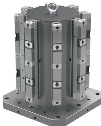
Flexible Anwendung des Mehrfach-Spannsystems auf einem Aufspannwürfel 8-seitig.
