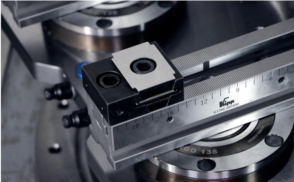
Keilspanner mit Festbacke des Mehrfach-Spannsystems Systembreite 50
