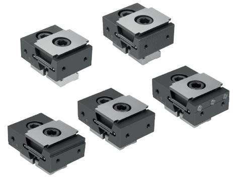
Die Keilspanner eignen sich durch ihr Funktionsprinzip für Mehrfachaufspannungen. Durch die Keilflächen werden große Spannkkräfte erreicht. Durch Eindrehen der Spannschraube bewegt sich das Spannsegment nach außen und drückt das Werkstück gegen den festen Aufsatzbacken. Durch das eingearbeitete Langloch im Doppelkeil können die Keilspanner verschoben werden bzw. Toleranzen ausgleichen.
