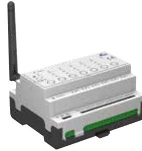
Das Gateway bildet die Schnittstelle zwischen den Arretierbolzen mit Zustandssensor und einer Maschinensteuerung. Es empfängt das Funksignal der Arretierbolzen und liefert an den Relais-Wechsler-Ausgängen ein für die Maschinensteuerung auslesbares binäres Ausgangssignal. Dadurch können die Betätigungszustände von bis zu 6 Arretierbolzen übermittelt werden. Zur zusätzlichen Visualisierung lässt sich ein mobiles Endgerät mit dem Gateway verbinden.
