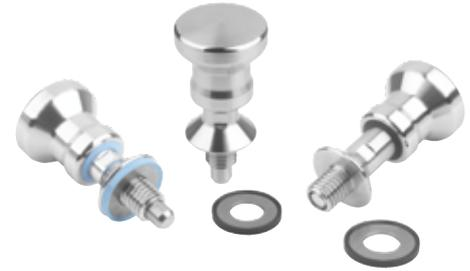
Arretierbolzen werden dort eingesetzt, wo eine Veränderung der Arretierstellung durch Querkräfte verhindert werden soll. Erst nach handbetätigter Ausrückung des Bolzens kann in eine andere Arretierstellung gefahren werden. Soll die Ausrückung über längere Zeit erfolgen und ein Zurückspringen des Arretierstiftes vermieden werden, so ist die Form C (mit Rastnut) zu verwenden.
