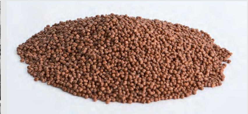
Beim Spritzgießen wird Bio-Kunststoffgranulat einer Maschine zugeführt, erwärmt, plastifiziert und mit über 1.000 bar Druck in das jeweilige Formwerkzeug eingespritzt.
