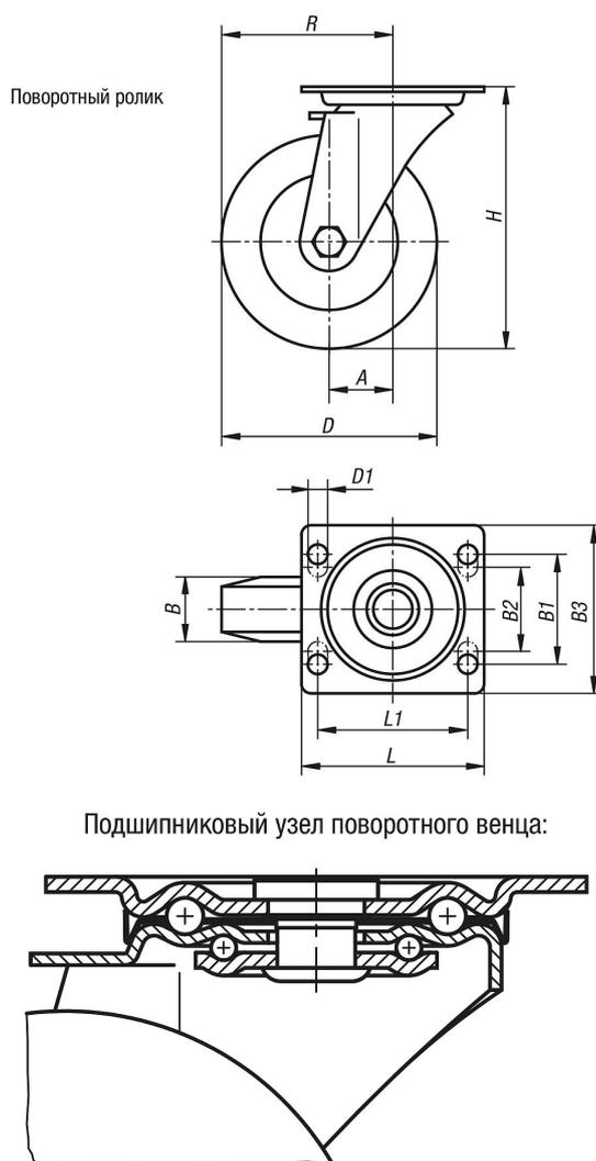
**Направляющие ролики из листовой стали, с вулканизированными эластичными цельнолитыми резиновыми шинами, стандартное исполнение**
