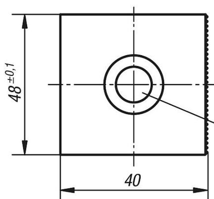
Сквозное отверстие для винта с цилиндрической головкой DIN 912, M12
