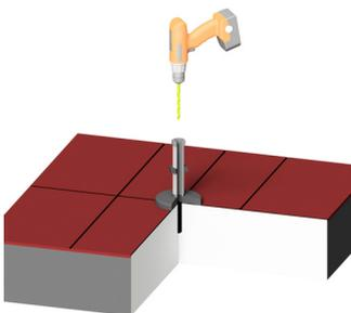
3. Insertar el tornillo prisionero o el perno y fijelo al suelo (por ejemplo, mediante adherencia).
