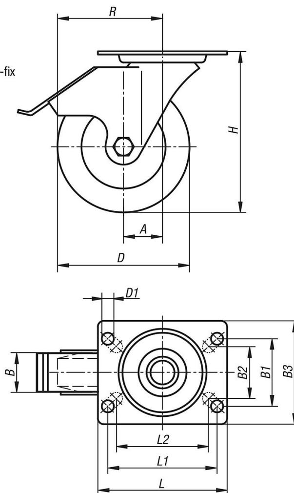
Направляющие ролики из нержавеющей стали, с функцией stop fix, с полиамидным колесом, стандартное исполнение
