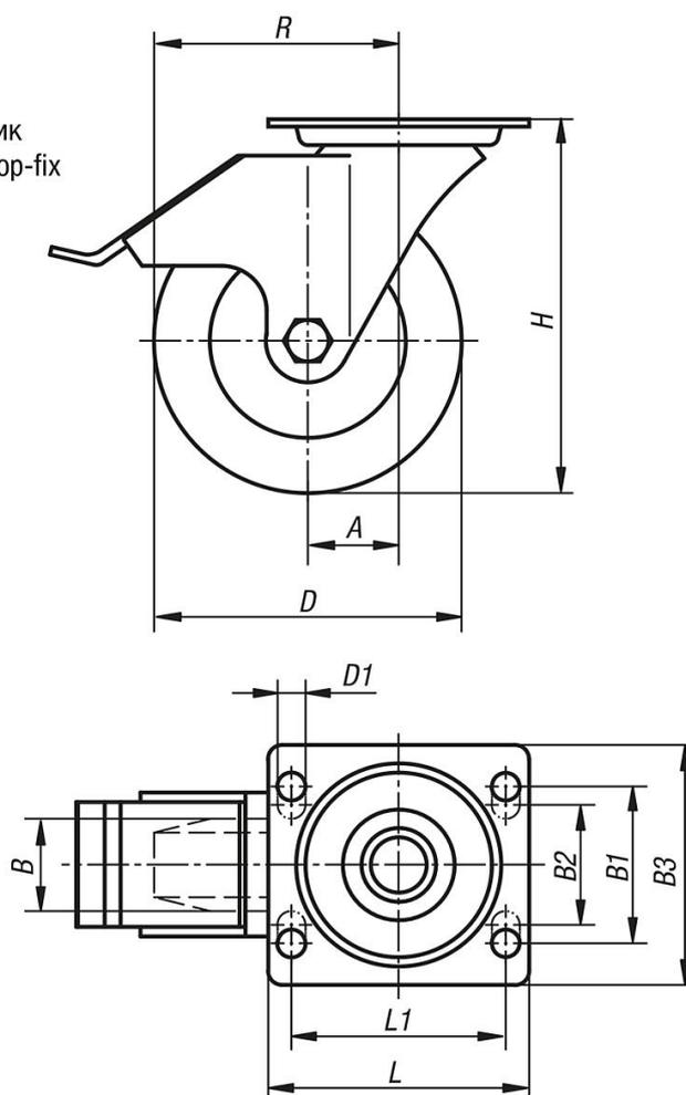
Направляющие ролики из листовой стали, с функцией stop fix, с вулканизированными эластичными цельнолитыми резиновыми шинами, стандартное исполнение
