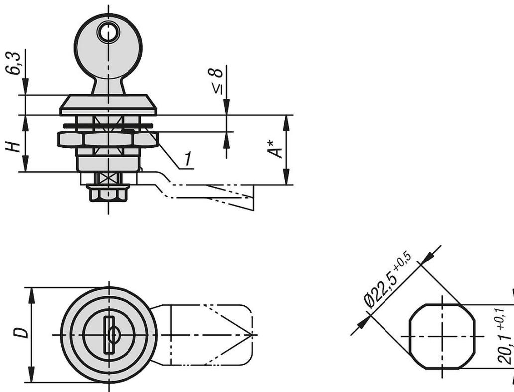
**Запираемые шпингалеты, нержавеющая сталь 1.4401, диаметр корпуса 30 мм****Обзор изделий**
