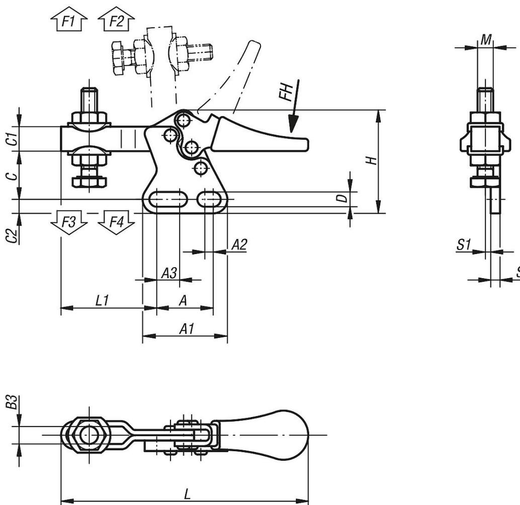
**Устройство прижимное горизонтальное с вертикальным основанием и регулируемым нажимным шпинделем, mini**
