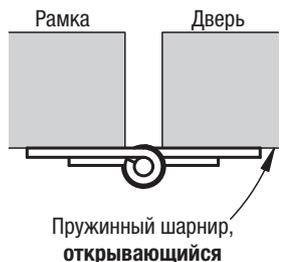
Стрелка показывает направление поворота шарнира под действием пружины.
