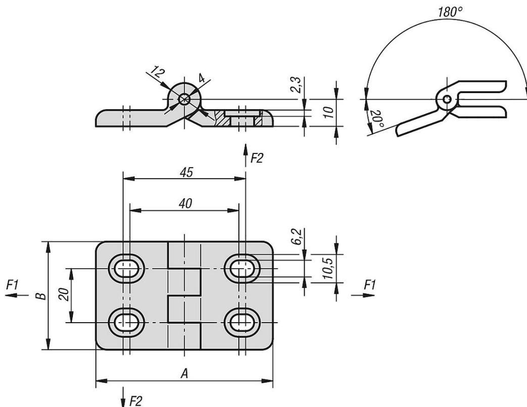
**Шарнир из пластмассы с удлинёнными отверстиями****Обзор изделий**
