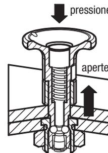
Para remover as placas, mantenha o botão apertado e retire o pino de bloqueio esférico da bucha de alojamento.
