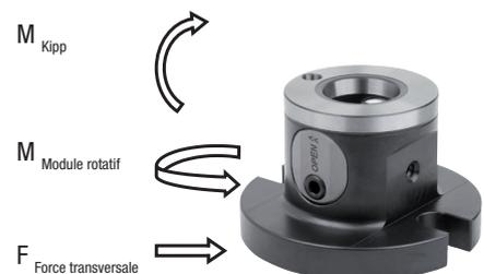
\* Jusqu'à une force transversale de 1.000 N, le fonctionnement correct des modules de bridage, notamment en ce qui concerne la répétabilité, est garanti. Jusqu'à une force transversale critique de 7.000 N, la sécurité en cas de défaillance et la sécurité des personnes sont garanties pour les modules de bridage.
