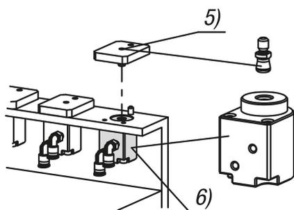
Logements de positionnement à bride en Inox pneumatiques
