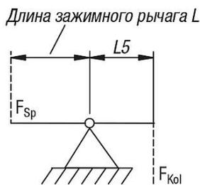
эффективное зажимное усилие  $F_{Sp}$  в зависимости от усилия на поршне  $F_{Kol}$  и длины зажимного рычага L
