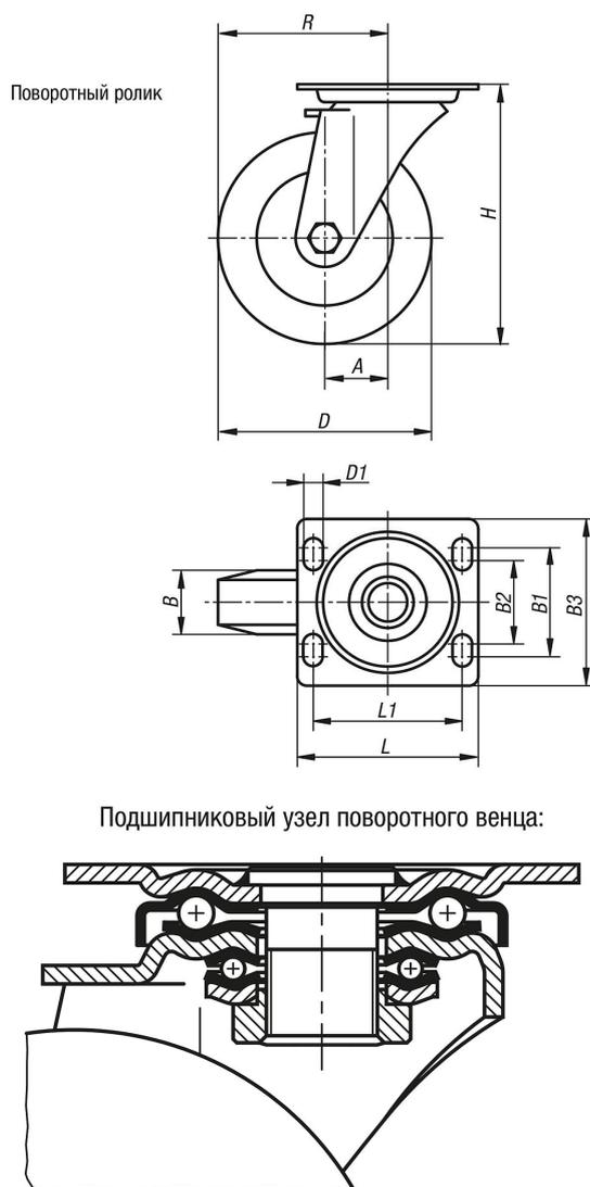
**Направляющие ролики из листовой стали, с покрытием обода Extrathane, усиленная конструкция****Обзор изделий**
