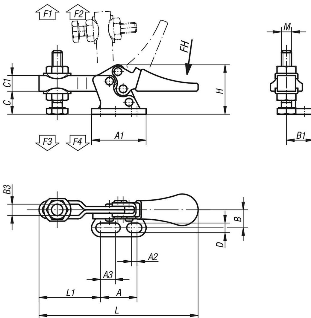
**Устройство прижимное горизонтальное с горизонтальным основанием слева и регулируемым нажимным шпинделем, mini**
