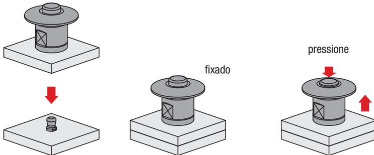
Instale o fecho de compressão sobre o pino de guia sem pressionar o botão. O processo de fixação é automático.
