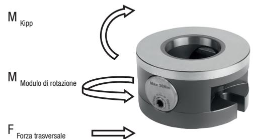
\* Fino a una forza trasversale di 3.000 N è garantito il corretto funzionamento dei moduli di serraggio, in particolare la ripetibilità. Fino a una forza trasversale critica di 20.000 N sono garantite la sicurezza personale e la sicurezza contro i guasti dei moduli di serraggio.
