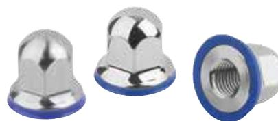
L'innovativo sistema di guarnizione a vite Hygienic DESIGN è stato sviluppato appositamente per l'uso in aree in cui vengono lavorati gli alimenti. È stata attribuita molta importanza alla geometria ottimizzata per la pulizia e alla rugosità superficiale di  $\leq 0,8 \mu\text{m}$ . L'intero pacchetto è completato dall'inserto del prodotto rapido e semplice attraverso un anello di tenuta già montato.
