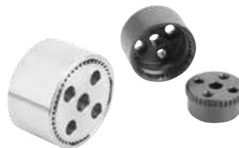
Si utilizzano elementi di arresto, per collegare due componenti in posizioni angolari a piacere ad accoppiamento geometrico tra loro. Gli elementi di arresto con dentatura interna (forma A-D) sono combinabili a piacere con gli elementi di arresto con dentatura esterna (forma E-H), a seconda del caso applicativo e della possibilità di montaggio. La molla di compressione supporta un rapido passaggio in una nuova posizione angolare.
