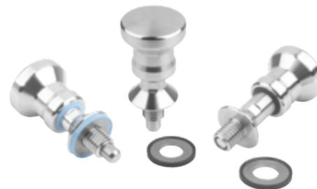
Le spine di posizione vengono utilizzate per impedire una modifica della posizione d'arresto per effetto di forze trasversali. Solo dopo il disinnesto manuale della spina è possibile modificare la posizione d'arresto. Si raccomanda l'utilizzo della forma C per evitare che il perno di bloccaggio si sgangi e se il disinnesto deve essere prolungato.
