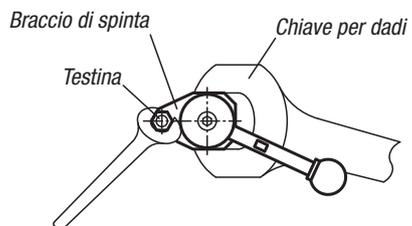
Se si monta una testina sul braccio tenditore, fissare il braccio tenditore con una chiave per dadi in modo da evitare l'assorbimento della forza torcente.
