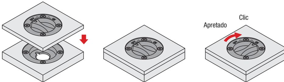
Comprobar que la empuñadura esté en la posición „OFF“. Colocar el pestillo de tensión de torsión en la placa de sujeción y girar la empuñadura a la posición „ON“. Cuando se cierra totalmente se oye una señal de clic.
