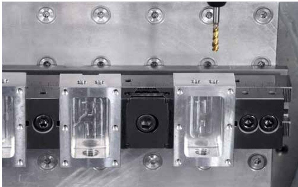
Das Mehrfach-Spannsystem mit Keilspanner doppelseitig und verschiedenen Festbacken kombiniert
