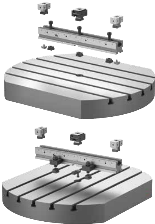
Montage des Mehrfach-Spannsystems in Längs- und Querrichtung auf T-Nutenmaschinentischen möglich. Ausrichtung mit Nutensteinen. Befestigung mit Befestigungsschrauben oder Spannpratzen.
