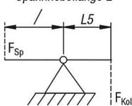
Effektive Spannkraft  $F_{Sp}$  in Abhängigkeit zur Kolbenkraft  $F_{Kol}$  und Spannhebellänge L
