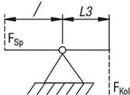
Effektive Spannkraft  $F_{Sp}$  in Abhängigkeit zur Kolbenkraft  $F_{Kol}$  und Spannhebellänge L
