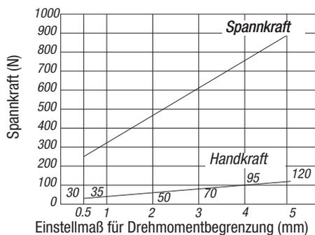
Bei einer Spannkraft von 900 N beträgt das Einstellmaß für die Drehmomentbegrenzung 5 mm, die Handkraft des Griffs beträgt 120 N.
