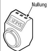
Die Nullstellung kann mittels Parameter um 5 sek. verzögert werden, um ein versehentliches Nullen zu verhindern.
