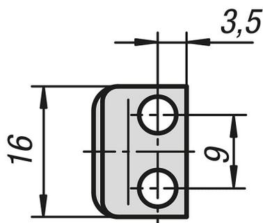
**Обратный крюк, для натяжных защелок, с пружинной скобой до 500 Н****Обзор изделий**
