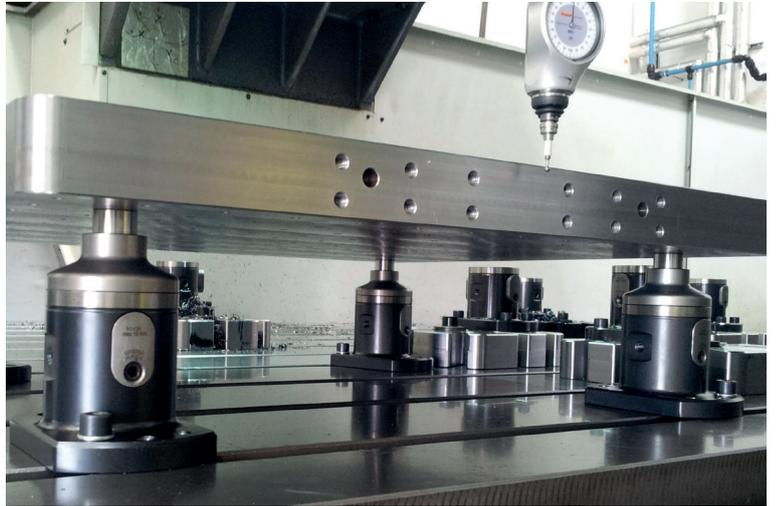
4x módulos básicos de dupla fixação posicionados sobre uma placa de fixação, permitem a usinagem ideal de 5 lados.
