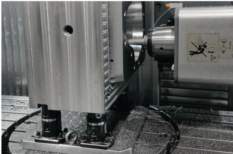
2 módulos básicos com um fixador central adaptado diretamente no sistema de fixação de ponto zero.
