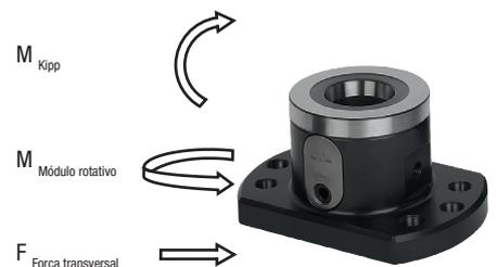
\* O funcionamento correto dos módulos de fixação, especialmente a repetibilidade, é garantida até uma força transversal de 1.500 N. A falha e a segurança pessoal dos módulos de fixação são garantidas até uma força transversal crítica de 14.000 N.
