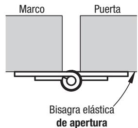
La flecha muestra la dirección de giro de la bisagra bajo el efecto del muelle.
